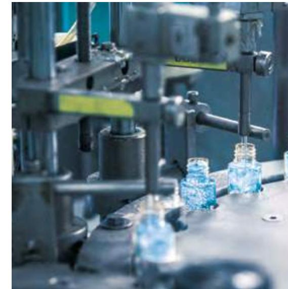
Riempimento dei flaconi attraverso linee d'avanguardia di derivazione cosmetico/farmaceutica, completamente automatizzate e di elevatissima capacità produttiva.
